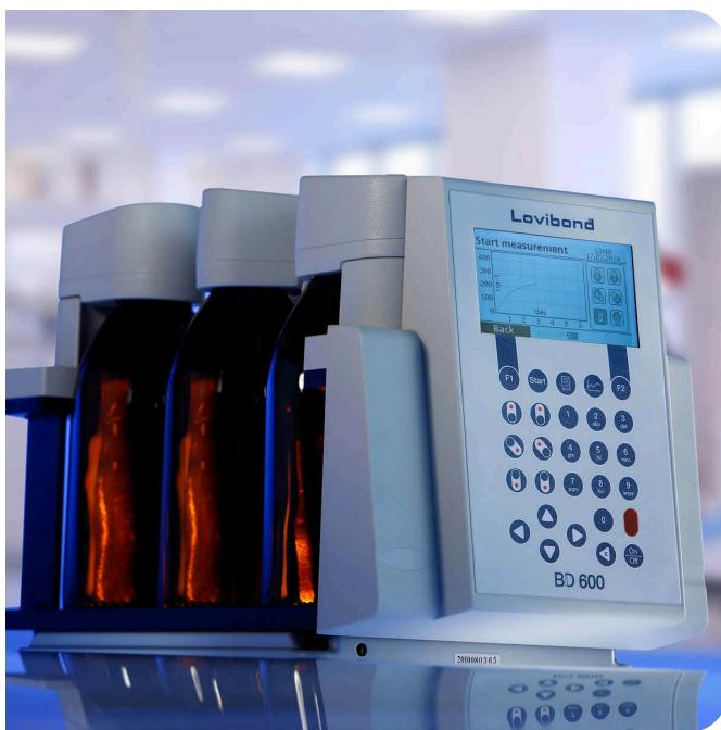
El BD 600 es el sistema ideal para el control de procesos o como prueba adicional de un método de dilución. La utilización de este sistema respirométrico soluciona muchos de los problemas vinculados al método de dilución de los análisis de DBO.
